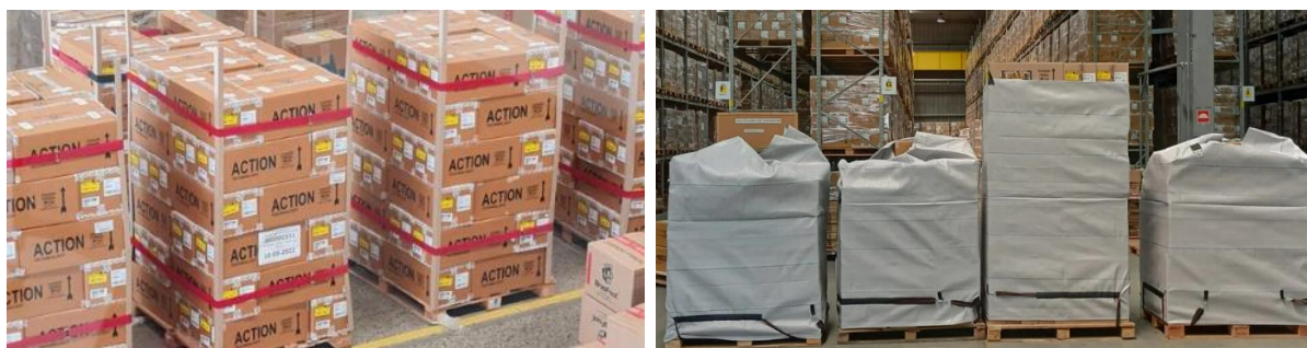
Figura 6 – Utilização das cintas e capas para imobilização das cargas
