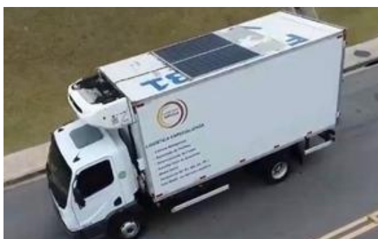
Figura 7 – Painéis solares localizado na parte de cima do veículo.
